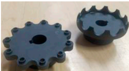
Figura 8. Ruedas conductora y conducida impresas en resina.
