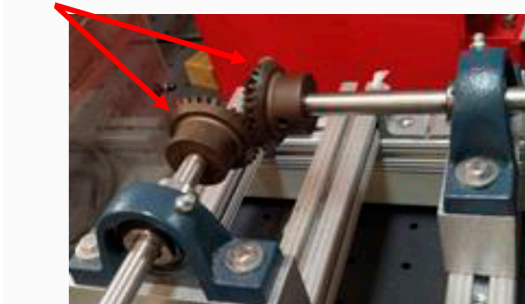
Figura 9. Montaje experimental de sistema de transmisión por engranajes cónicos.
