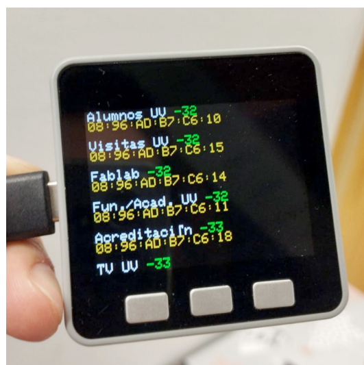
Figura 2. M5 stack core utilizado para levantamiento de MACs.
