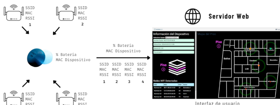
Figura 1. Esquema de funcionamiento del TAG WiFi.
