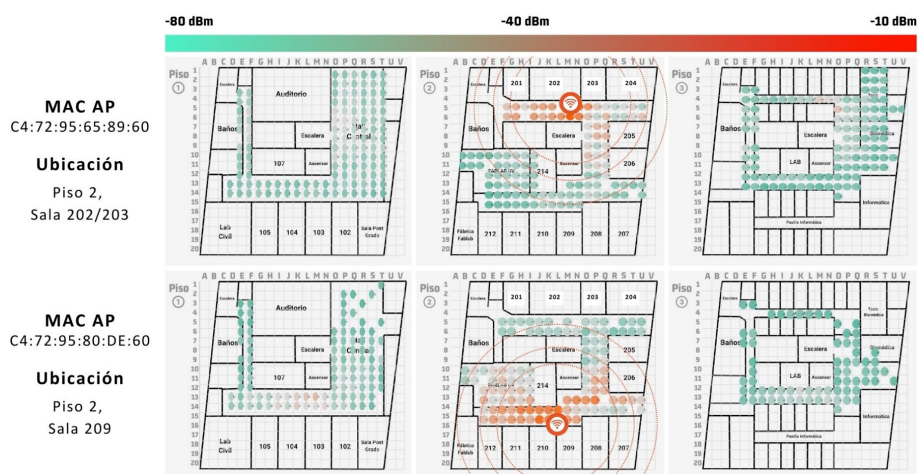
Figura 16. Resultado gráfico de mediciones RSSI de 2 puntos de acceso seleccionados en piso 2 y su efecto en pisos 1 y 3.
