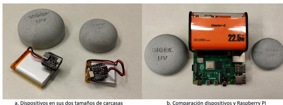
Figura 13. Dispositivos finales y comparación de tamaños.
