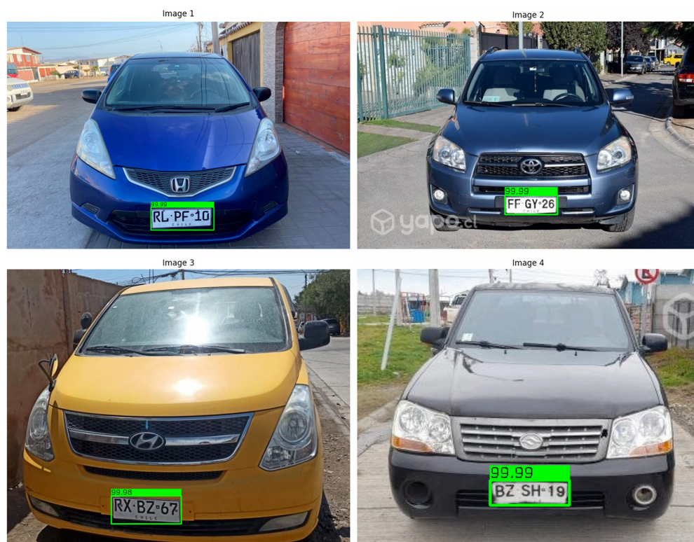
Figura 6. Resultados de la detección de la placa con buena iluminación.
