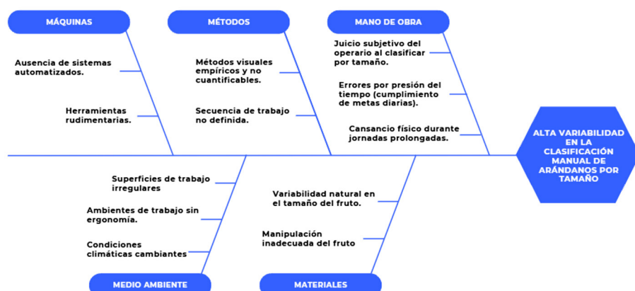
Figura 2. Diagrama Ishikawa correspondiente al análisis representativo de los factores causales referentes a la variabilidad del proceso manual de clasificación de arándanos por tamaño.
