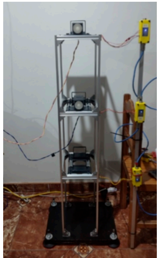
Figura 4. Instalación de acelerómetros en los niveles del módulo.
