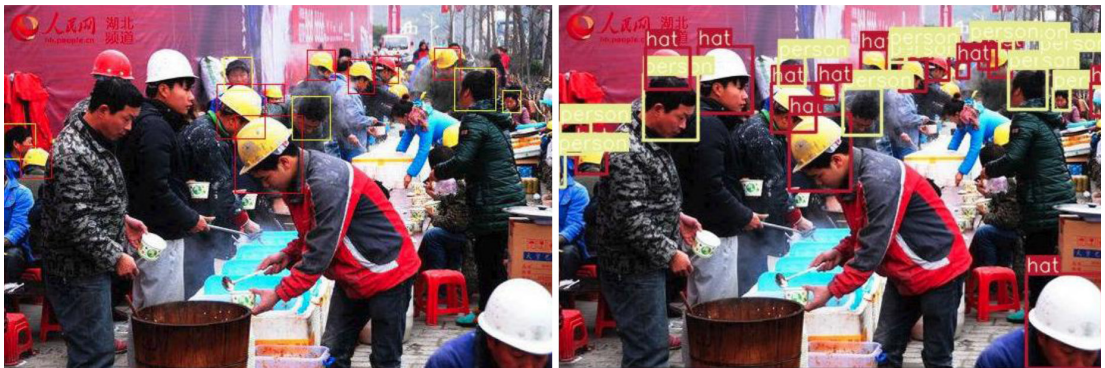
Figura 7. Ejemplo de detección con baja precisión obtenida sobre el conjunto de prueba de la base de datos SHWD. La imagen de la izquierda contiene las anotaciones originales y la de la derecha a las predichas.
