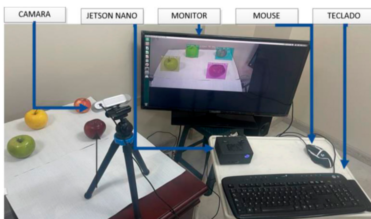
Figura 6. Configuración del experimento y sistema de adquisición de imágenes.
