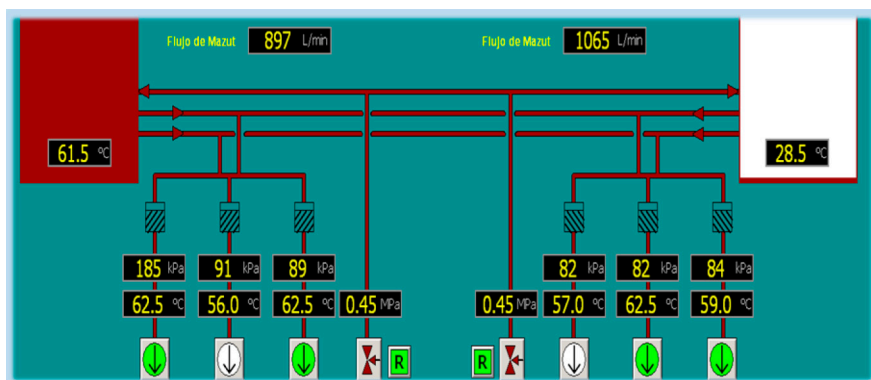
Figura 2. Esquema del sistema de adquisición de datos experimentales, Intouch 9.0.
