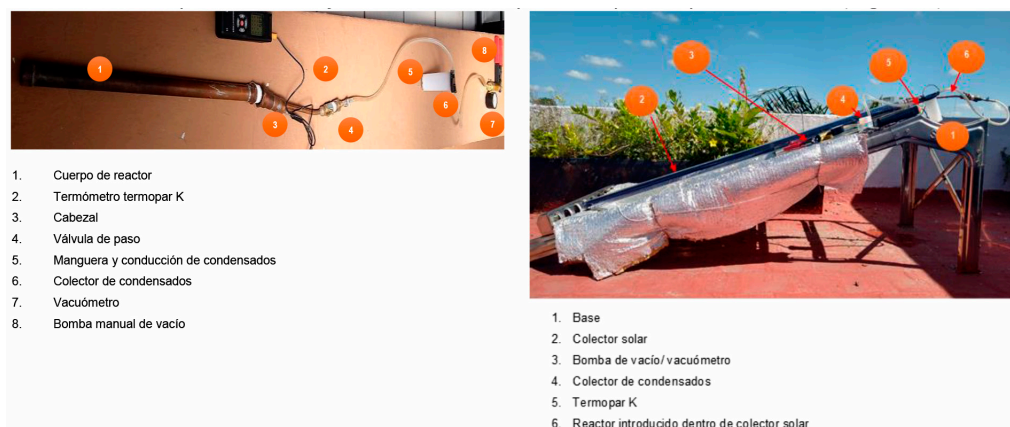
Figura 4. Partes y ensamble del prototipo funcional de reactor solar.
