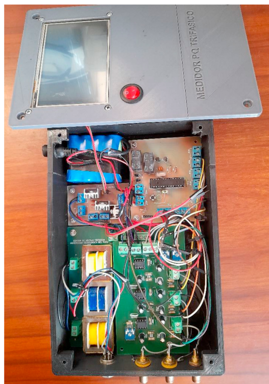
Figura 2. Caja del analizador de redes y tapa con la pantalla táctil.
