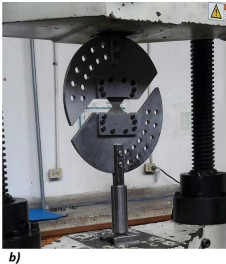
Figura 1. Configuración del dispositivo tipo Arcan: a) explosionado con numeración de componentes. [10], b) montaje en la máquina de ensayos universales Shimadzu UH-500-knNI.
