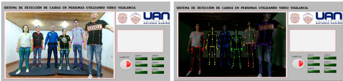
Figura 3. Sistema de monitoreo y esqueletización para 6 personas con diferentes niveles de iluminación.
